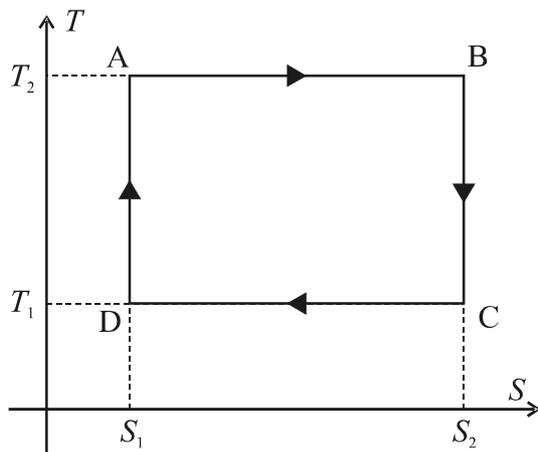
As máquinas térmicas podem ser estudadas analisando-se o ciclo termodinâmico que representa os processos físicos que ocorrem em seu interior. A figura acima ilustra o ciclo no espaço temperatura ( $T$ ) versus entropia ( $S$ ) de uma máquina térmica cujo fluido de trabalho é um gás monoatômico ideal.
