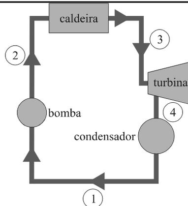
Uma usina termoelétrica funciona como um ciclo de potência a vapor, conforme esquematizado na figura acima. O funcionamento da usina consiste, essencialmente, em quatro processos, conforme descrito a seguir.
