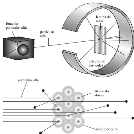
O cientista neozelandês Ernest Rutherford, ganhador do prêmio Nobel de Química, em 1908, propôs um modelo atômico baseando-se em experimentos com radioatividade. Para comprovar a eficiência de seu modelo, ele realizou o experimento esquematizado na figura acima, no qual uma fina lâmina de ouro foi bombardeada por um feixe de partículas alfa, produzindo uma imagem em um detector de partículas. Ele observou que parte das partículas alfa mudava a direção de sua trajetória ao encontrar a lâmina.
