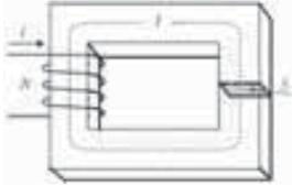
Por terem permeabilidade magnética milhares de vezes maior que a do vácuo ( $\mu_0$ ), os materiais ferromagnéticos são usados para se garantir que praticamente todo o fluxo magnético fique confinado em seu interior, havendo pouca perda de fluxo para o exterior (ar atmosférico). Com esses materiais, são criados circuitos que utilizam campos magnéticos.
