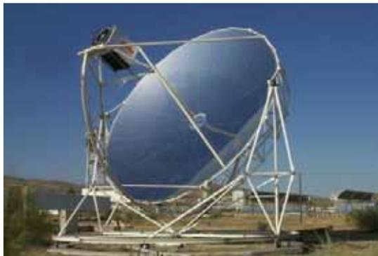
Uma possibilidade moderna de geração de energia elétrica a partir da energia solar consiste no emprego de grandes espelhos côncavos de Gauss — espelhos ideais produzidos com base na calota de uma esfera —, que concentram a radiação solar em motores Stirling, localizados no foco do espelho. O calor gerado pela concentração da energia solar, que produz temperaturas de até 250 °C, atua como a fonte quente em um motor Stirling, que, por sua vez, gera energia elétrica.
